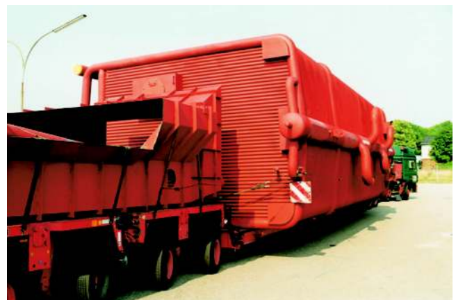
Bild 2: 100 MW Heißwasser-Wasserrohrkessel beim Transport
